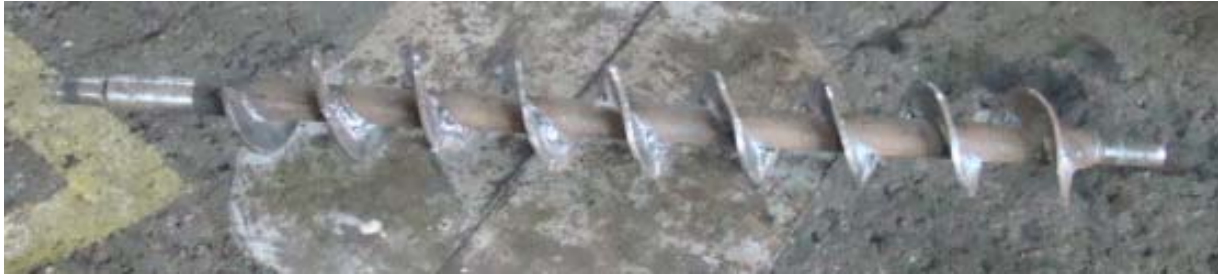
Figura 3.1 Tornillo sin fin, tensado y soldado al eje.
