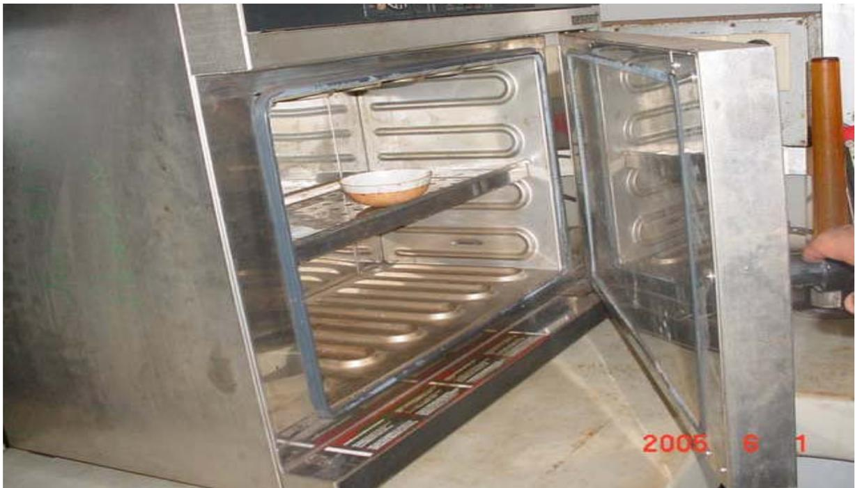
Figura 5. Estufa empleada para el secado de las muestras de mineral.
