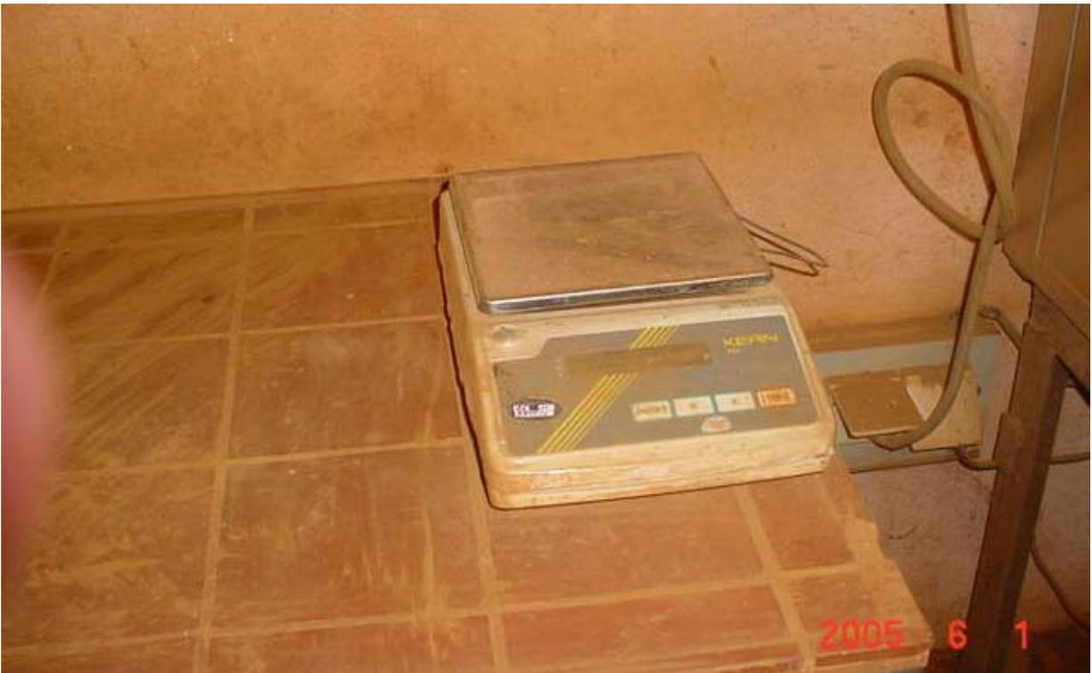
**Figura 4.** Balanza digital utilizada para el pesaje de las muestras.
