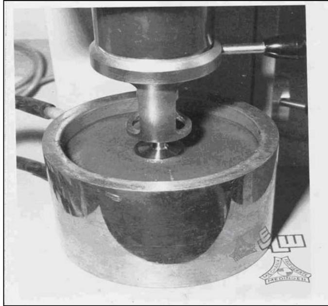
Figura 1: Viscosímetro rotacional de rotor en medio infinito
