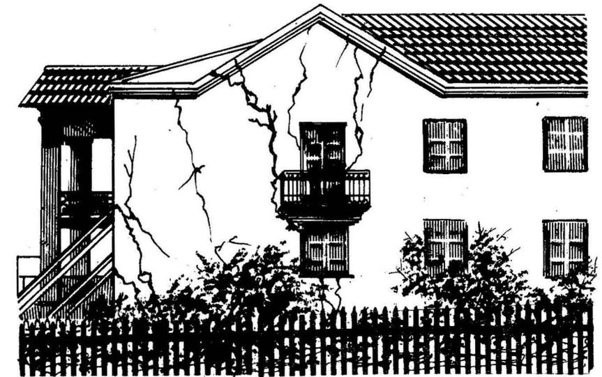
Fig. 6.2 Edificio afectado por el movimiento de las rocas mineras
