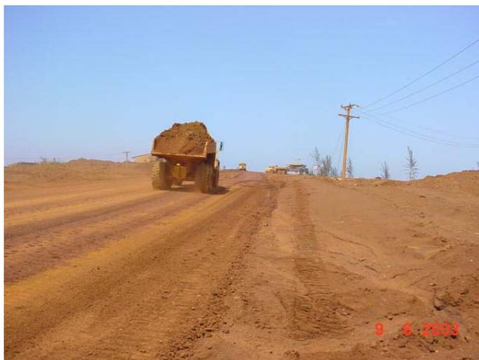
Foto 9. Levantamiento de polvo provocado por el transporte de la masa minera, [Guerrero, (2003)].
