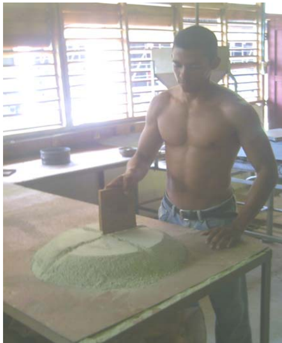
Foto 2.4.- Vista del empleo del método del cuarteo
