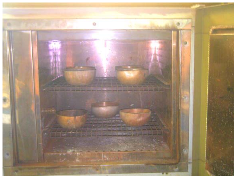
Figura 2.- Estufa utilizada para el secado de las muestras antes de la molienda y después del tamizado húmedo
