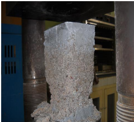
Ensayo a la resistencia a compresión del bloque morteros
