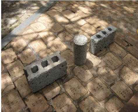
Bloque y testigo realizado con el 50% del material de rechazo.
