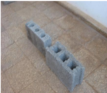
Bloque realizado con el 50% del material de rechazo
