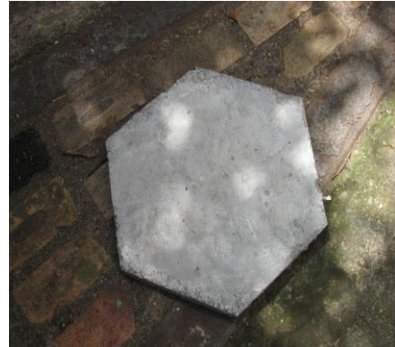
Losa realizada con el 50% de rechazo.
