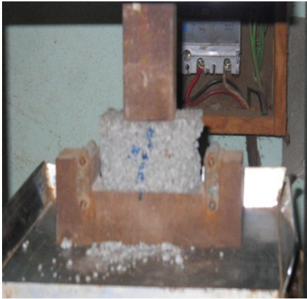
Ensayo a la resistencia a compresión del mortero
