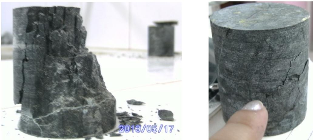
Figura 8 Aspecto de las muestras al culminar el ensayo de resistencia a tracción.
