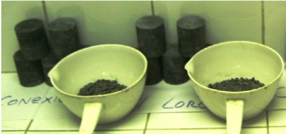
Figura 7 Aspecto de las muestras al culminar el ensayo de resistencia a compresión.
