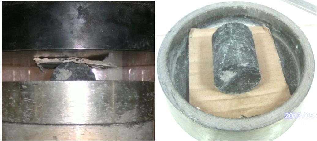
**Figura 10** Ensayo de resistencia a compresión.
