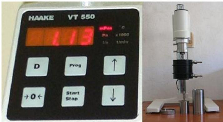
Figura 2.1. Viscosímetro rotacional HAAKE VT550.
