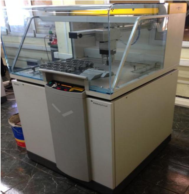
Figura 2.4 Equipo de FRx utilizado para la caracterización química.
