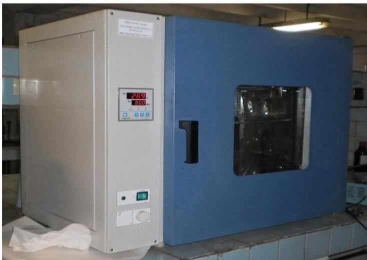
Figura 2.9 Estufa de control digital utilizada para el secado de las muestras.
