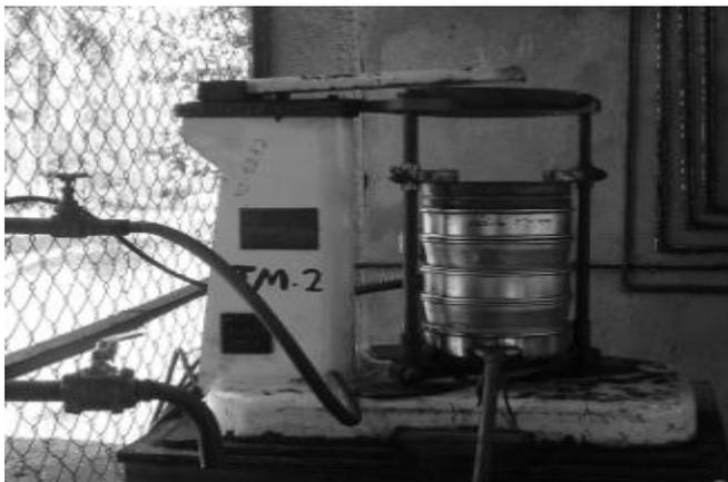
Figura 2.6 Tamizadora digital adaptada, modelo R.X.-29
