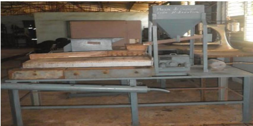
Figura 2.8 Mesa de concentración utilizada en la experimentación.
