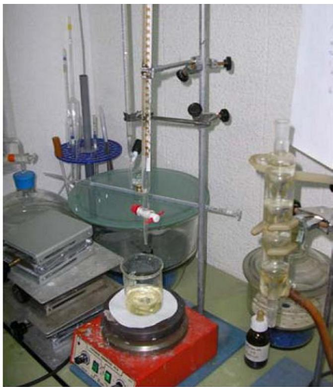
**Figura 2.7** Fotografía que muestra el agitador magnético “Bunsen”. Se muestra la tonalidad amarilla luego de ser agregado el indicador de naranja de metilo.
