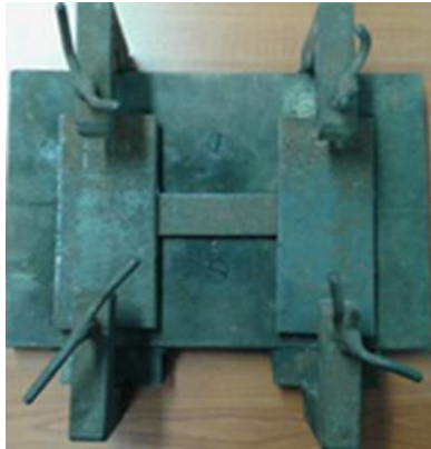
Figura 2.1: Fijación de las chapas para evitar la deformación durante la deposición.
