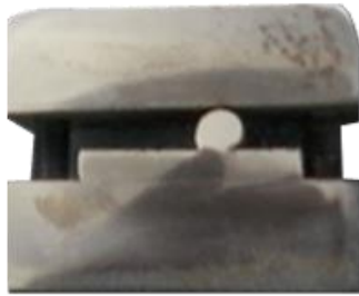
Figura 2.4: Imagen de la muestra montada en el soporte para la preparación metalográfica.
