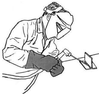
Figura 1.1: Esquema de la realización práctica del proceso SMAW (Solas, 1987).
