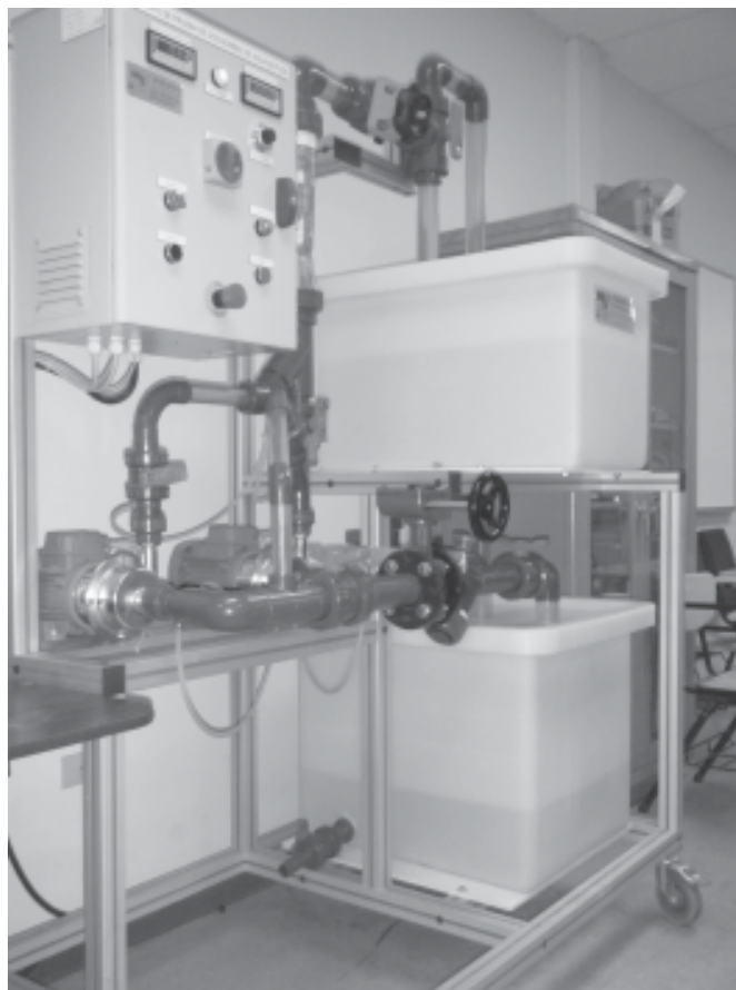
Fig. 2. Banco de pruebas de bombas centrífugas con variador de velocidad.
