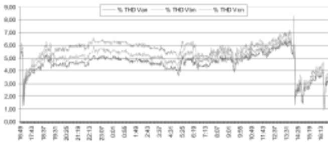
Fig.5. Comportamiento de la distorsión total armónica de tensión en el bungalow 2
