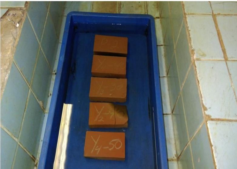
Figura 2.9 Ensayo a la absorción de agua
