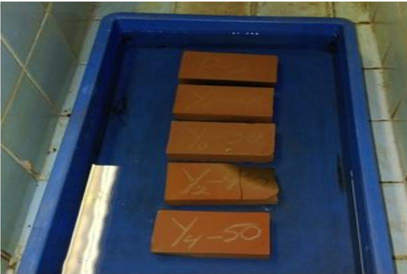
Figura 2. 11 Ensayo de absorción de agua
