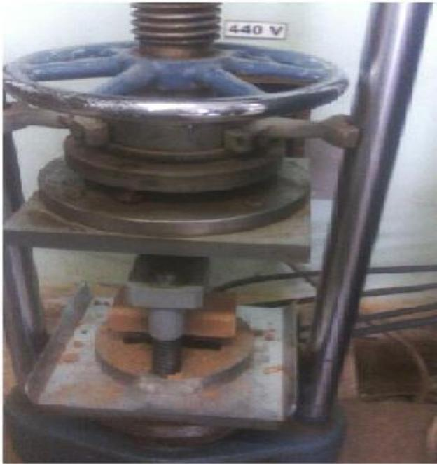
Figura 2.10 Ensayo de resistencia a la compresión
