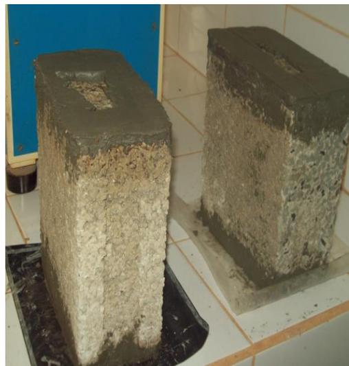
**Figura 5: Bloques con el Capping.**
