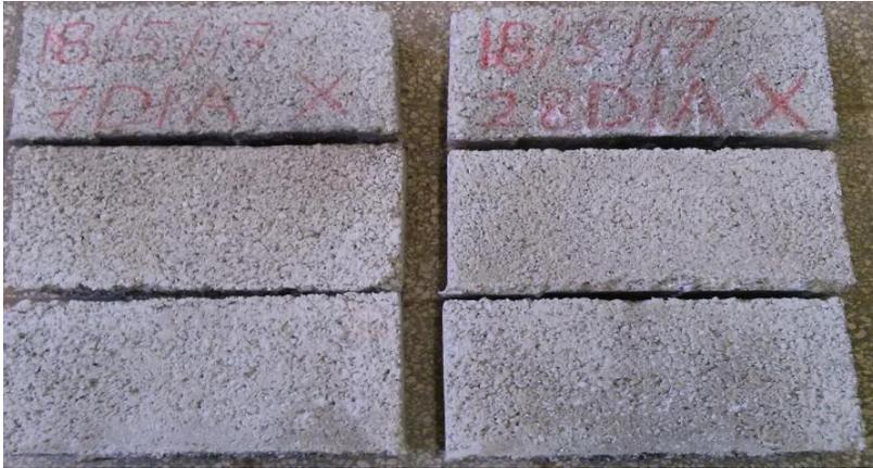
**Figura 10: Bloques patrones para el ensayo de resistencia a la compresión a la edad de 7 y 28 días.**
