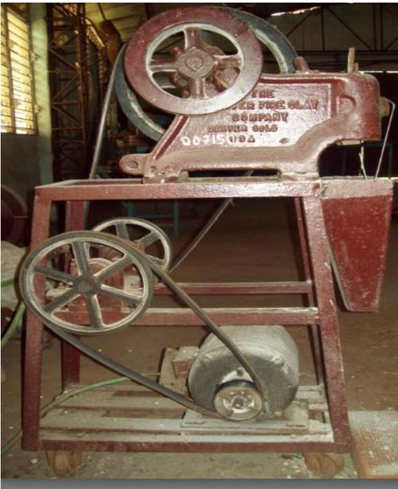
Figura 2: Trituradora de mandíbula TQ 150 x 75 mm.
