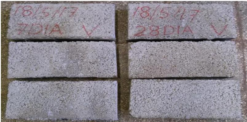
**Figura 11: Bloques de toba vítrea para el ensayo de resistencia a la compresión a la edad de 7 y 28 días.**
