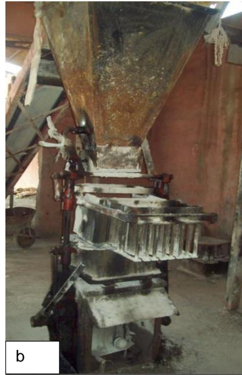
**Figura 3: Maquina estacionaria de fabricación de bloques, a; parte delantera, b; parte trasera.**
