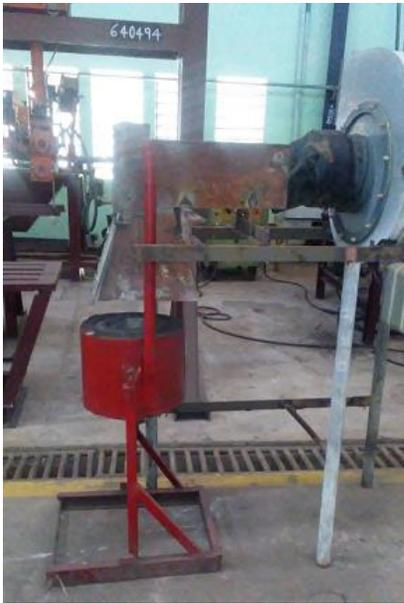
Fig. 2.1 Reactor aluminotérmico
