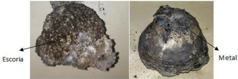
Figura 3.1 Escoria y metal obtenidos en el procesamiento aluminotérmico de la carga 1:1000 g
