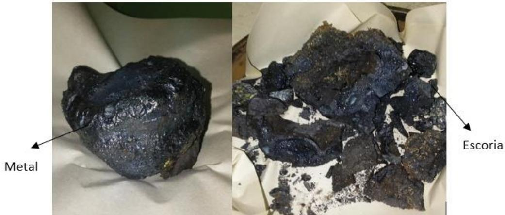
Figura 3.3 Escoria y metal obtenidos en el procesamiento aluminotérmico de la carga 3:500 g
