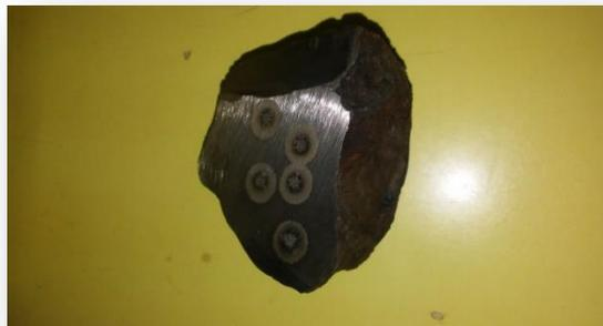
Figura 3.4 Probeta utilizada para el análisis químico
