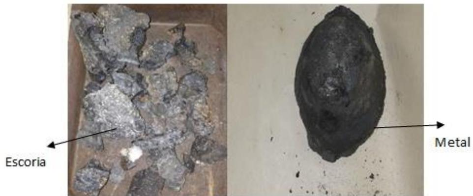
Figura 3.2 Escoria y metal obtenidos en el procesamiento aluminotérmico de la carga 2:500 g
