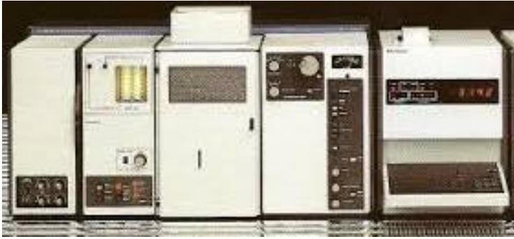
Fig. 2.6 Espectrofotómetro de absorción atómica
