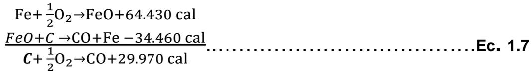
Como resultado se obtiene CO que se desprende en forma de gas. Las burbujas de CO que se forman pasan a través de la escoria espumándola.
