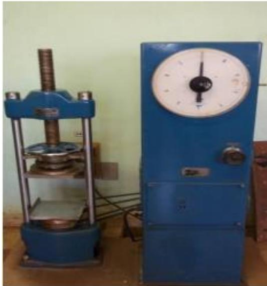
Figura 2.7. Prensa hidráulica de 10 t
