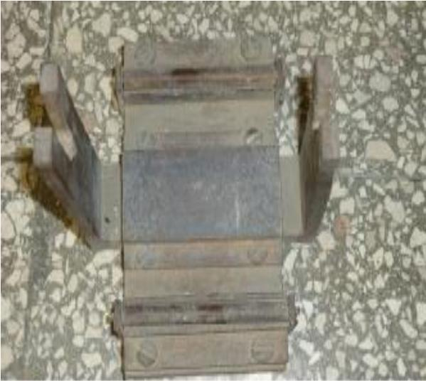
**Figura 2.9** Aditamento especial para el ensayo de compresión
