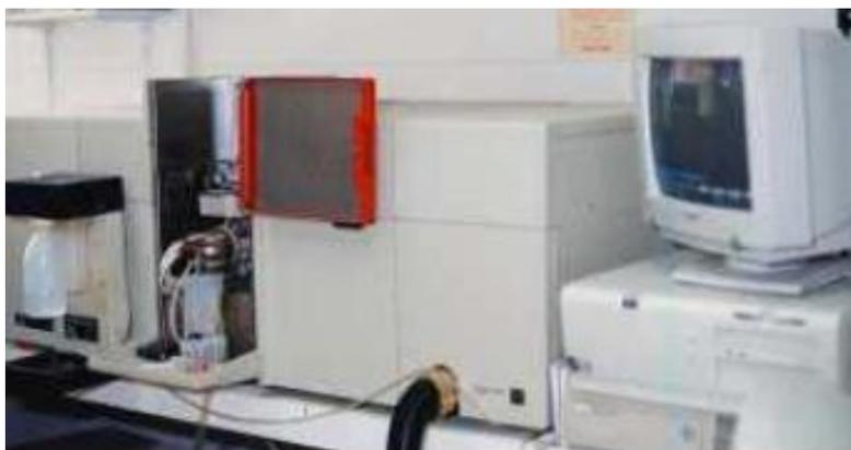
**Figura 2.6** Equipo de Espectroscopia de Absorción Atómica. Tomado de (Araque Tineo, 2012)
