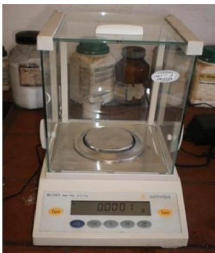
**Figura 2.7** Balanza utilizada para el pesaje de las muestras.
