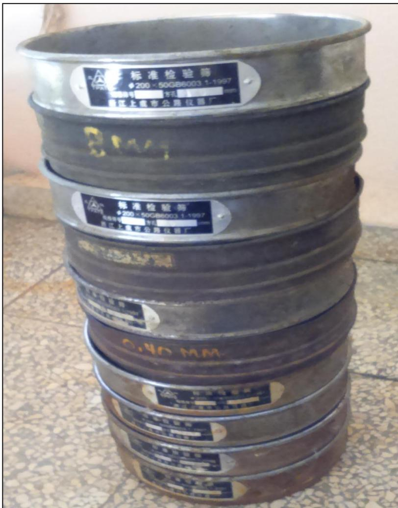
**Figura 2.4.** Juego de tamices utilizados en el análisis granulométrico.
