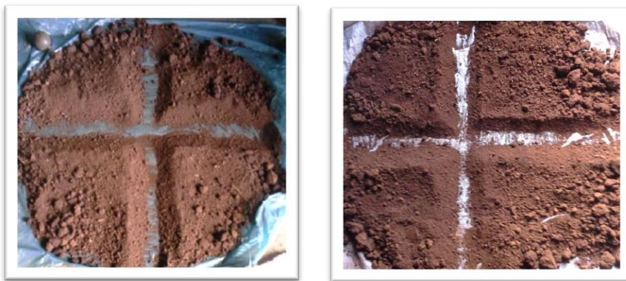
**Figura 2.2** Procedimiento del cuarteo manual realizado a los escombros a) del área 1 b) del área 2, muestra que tratada granulométricamente a modo de comparación con la muestra del área 1.
