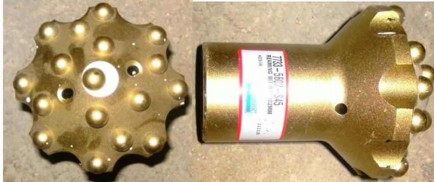
Figura 20. Broca de 46 mm para barrenos de corte, arranque y contorno
