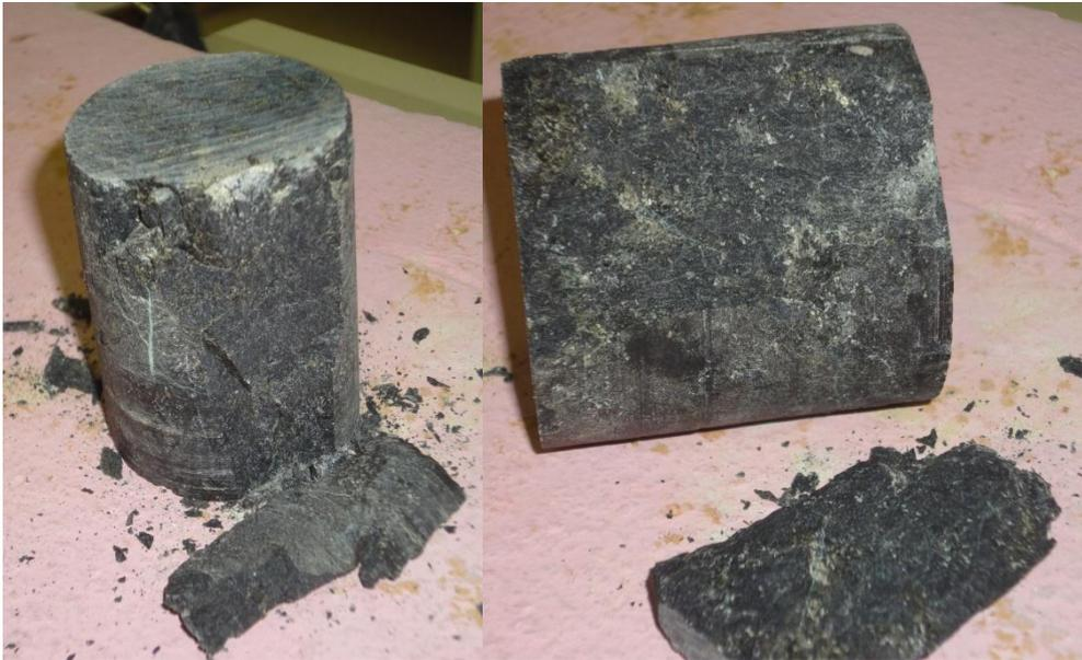
Figura 8. Ensayo de resistencia a compresión
