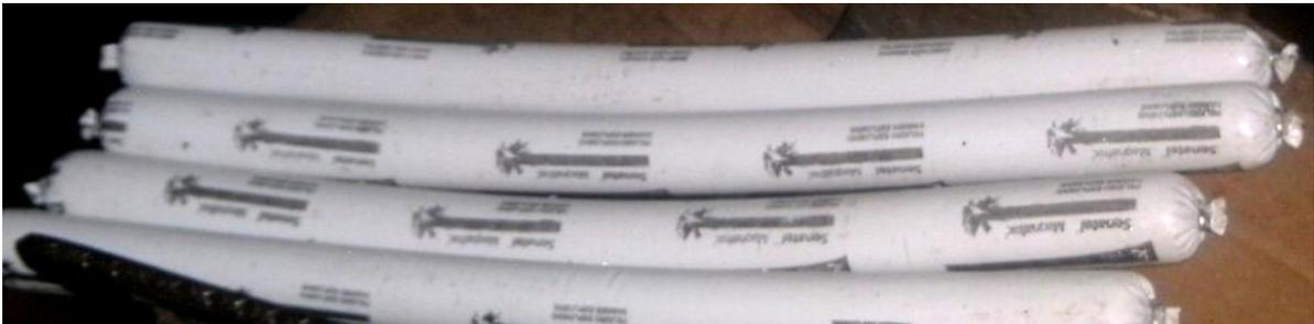
Figura 15. Cordón Detonante 10 g/m (a la izquierda) y Cordón Detonante de 42 g/m (a la derecha)
