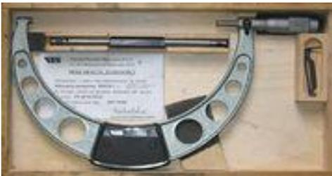
**Figura 2.4.** Micrómetro.
