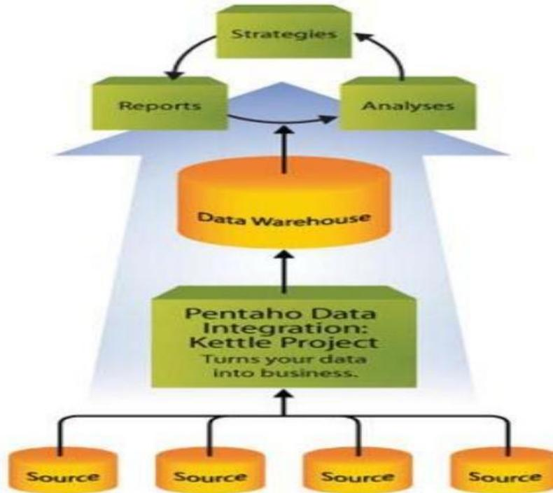
Figura 5: Representación de la arquitectura de Kettle.
