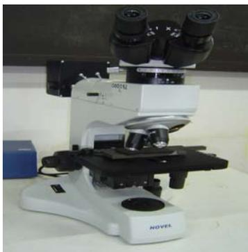
Figura 2.3. Microscopio óptico NOVEL modelo NIM - 100.
