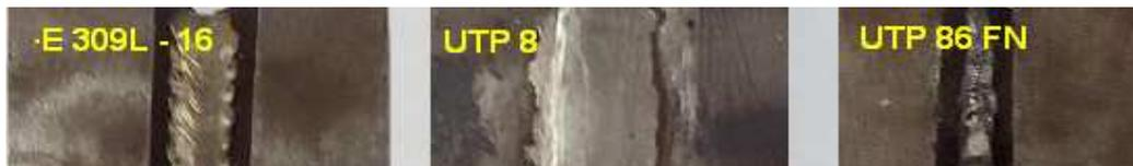
Figura 2.3. Corte de las muestras metalográficas.
