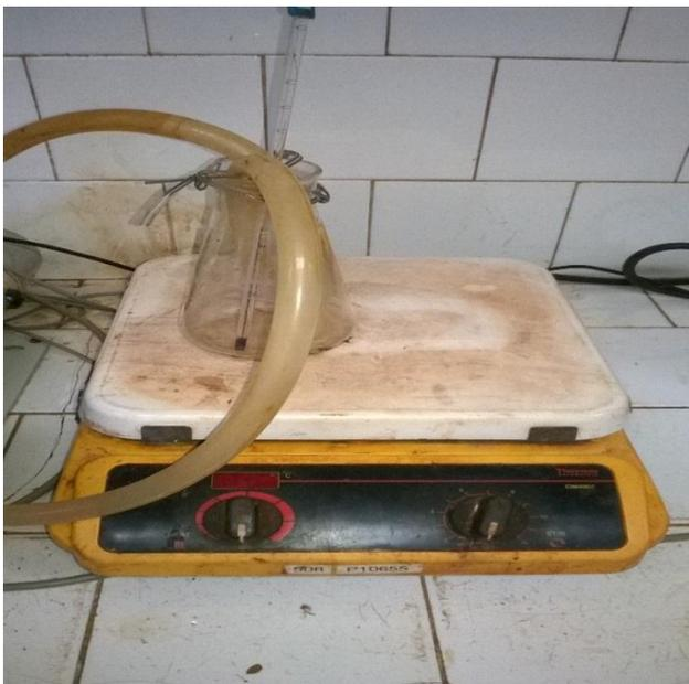
**Figura A.2.5** Plancha Térmica Cimarec.
