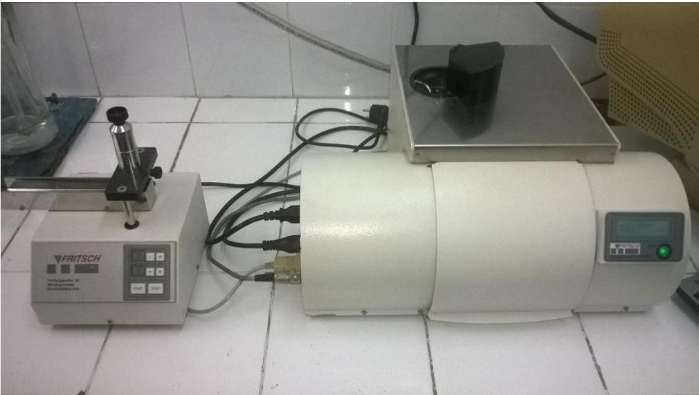
**Figura A.2.7** Analizador de tamaño de partículas “Analysette 22” COMPACT.
