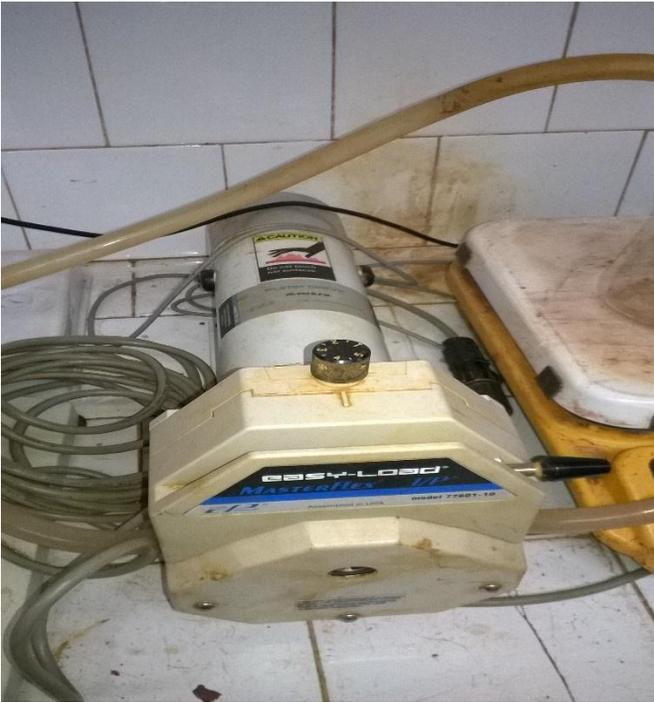
**Figura A.2.6** Bomba de flujo. Master Flex Modelo 77601-10.
