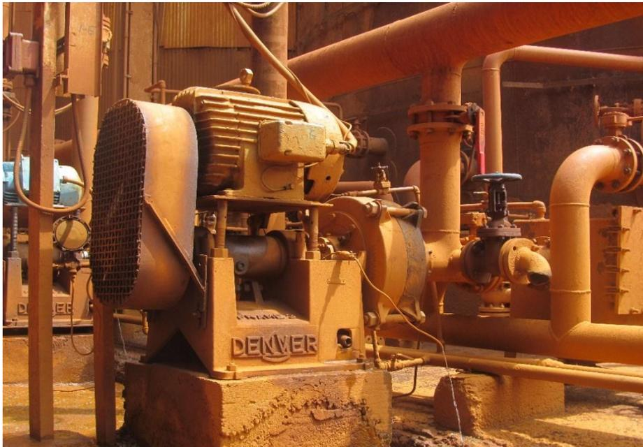
**Figura 1.3.** Bomba centrífuga DENVER 5x4 SRL
