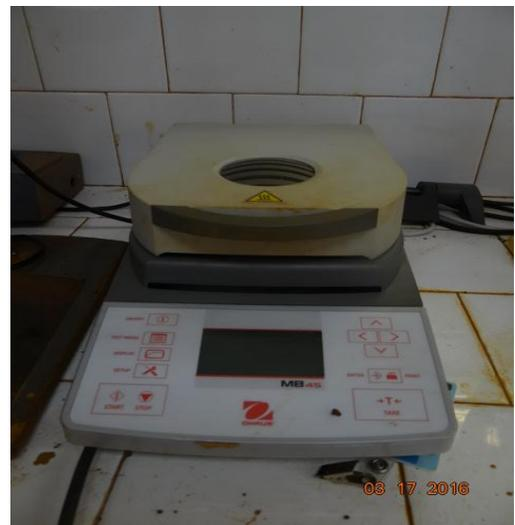
Figura A.2.3 Balanza Secadora Ohaus.
