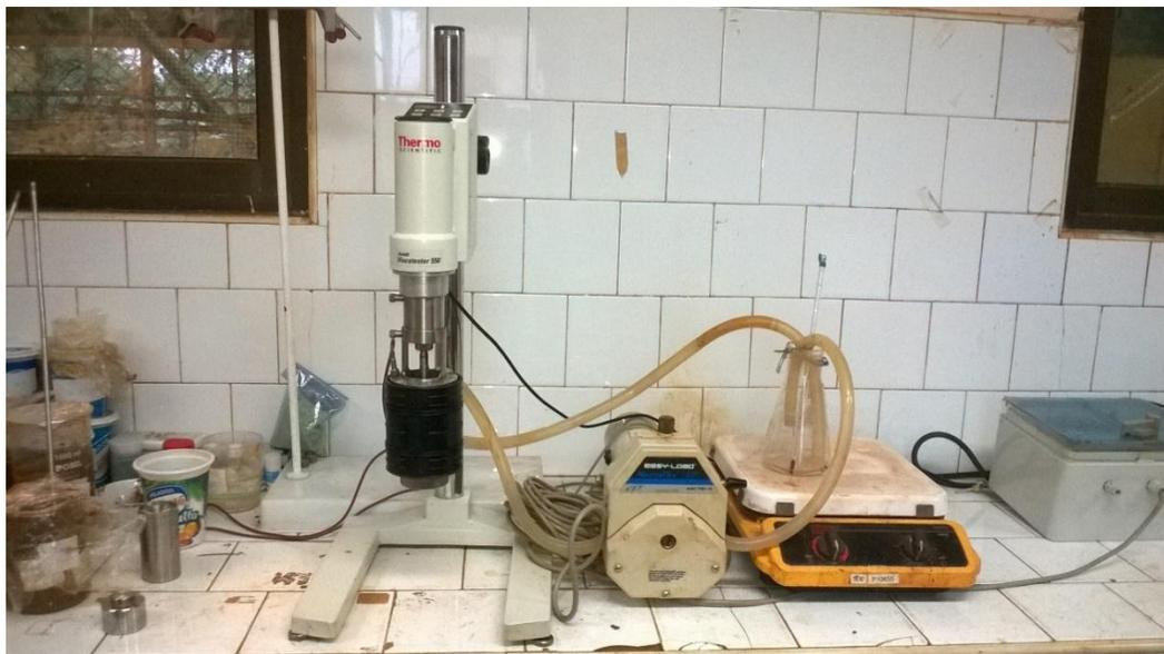
**Figura 2.1.** Viscosímetro HAAKE 550 conectado a una bomba de flujo para hacer recircular agua caliente y garantizar la temperatura de la pulpa.
