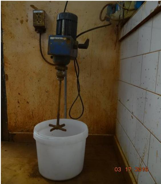
**Figura A.2.4** Agitador con impelente mecánico IKA RW 28.
