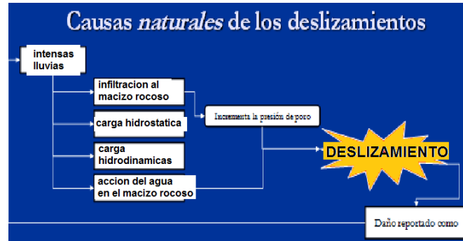
Figura 5. Causa de fallo por deslizamientos por intensas lluvias
