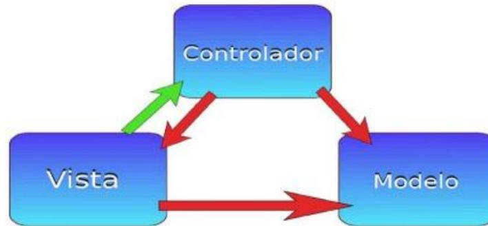
Figura 1.2: Estructura MVC.
