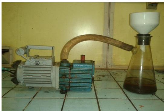
Figura 2.5 Intalación de filtración
