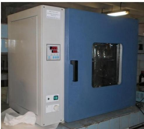
Figura 2.2 Estufa utilizada para el secado de las muestras.
