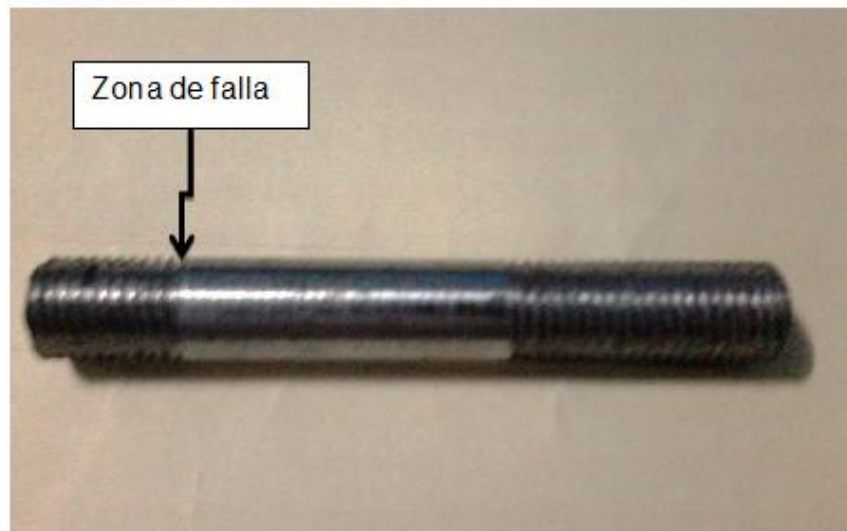
Figura 3.1. Diagrama del espárrago mostrando la zona de falla.
