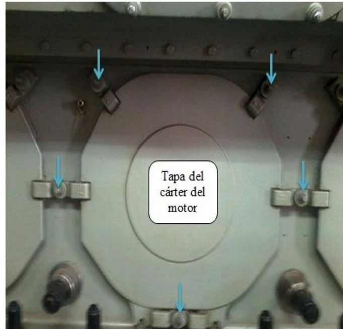
Figura 3.3. Ubicación de los espárragos en el cárter del motor (flechas azules).
