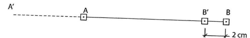
Fig. 3.3. Determinación de los errores de la distancia.
