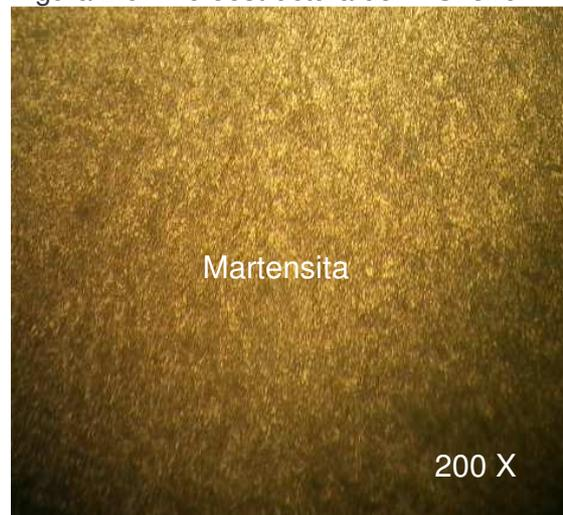
Figura 2.8. Microestructura acero AISI 1050
