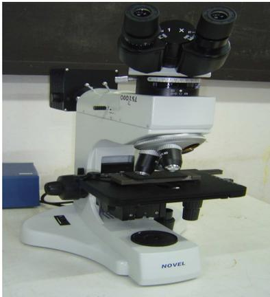
Figura 2.4. Microscopio óptico NOVEL modelo NIM - 100.
