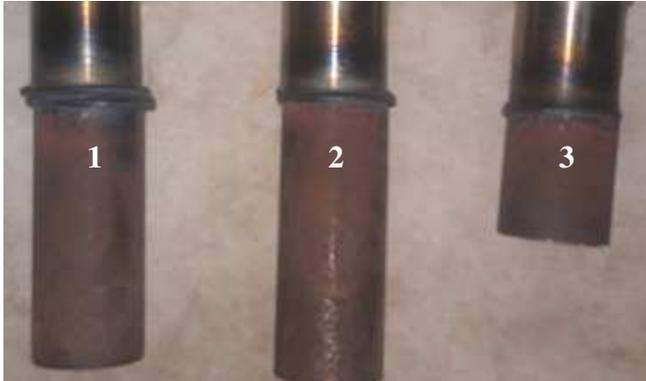
Figura 2.5. Probetas obtenidas luego del proceso de soldadura.
