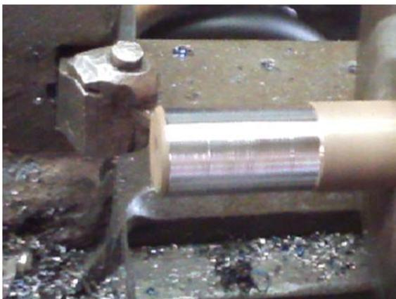
Figura 2.2. Instalación de la pieza a maquinar.
