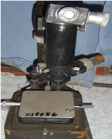
Figura 2.8. Microscopio metalográfico para medición de microdureza.
