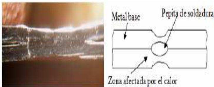
Figura 2.3. Vistas transversales de la penetración de la soldadura por resistencia.
