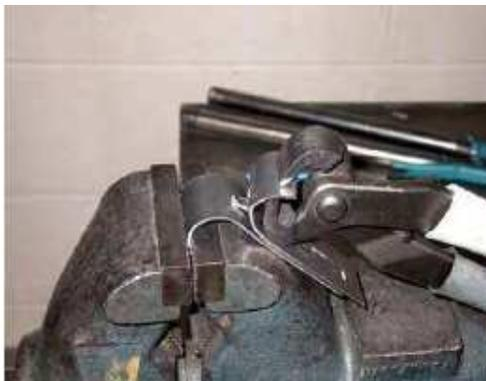
Figura 2.8. Procedimiento para determinar el porcentaje de penetración.
