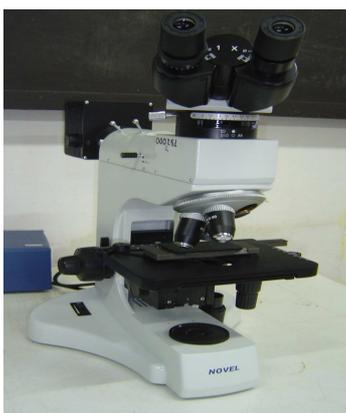
Figura 2.5. Microscopio óptico NOVEL modelo NIM - 100.
