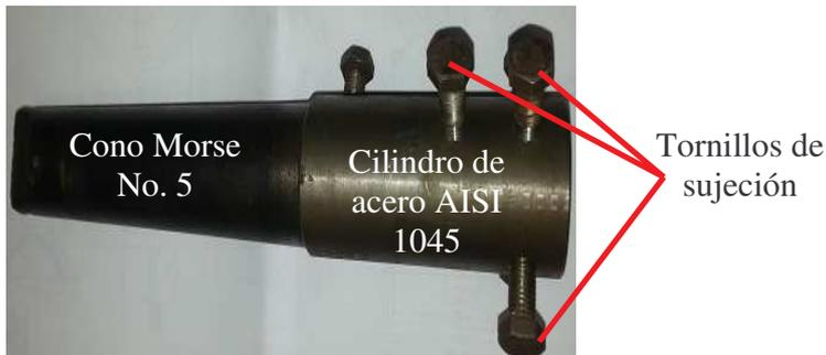
Figura 2.4. Dispositivo empleado en el proceso de soldadura.
