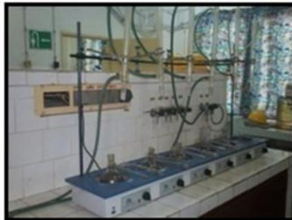
Figura 2.7. Plancha de calentamiento para la determinación de porcentaje de agua
