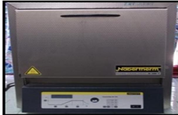
Figura 2.5. Horno mufla Nabertherm
