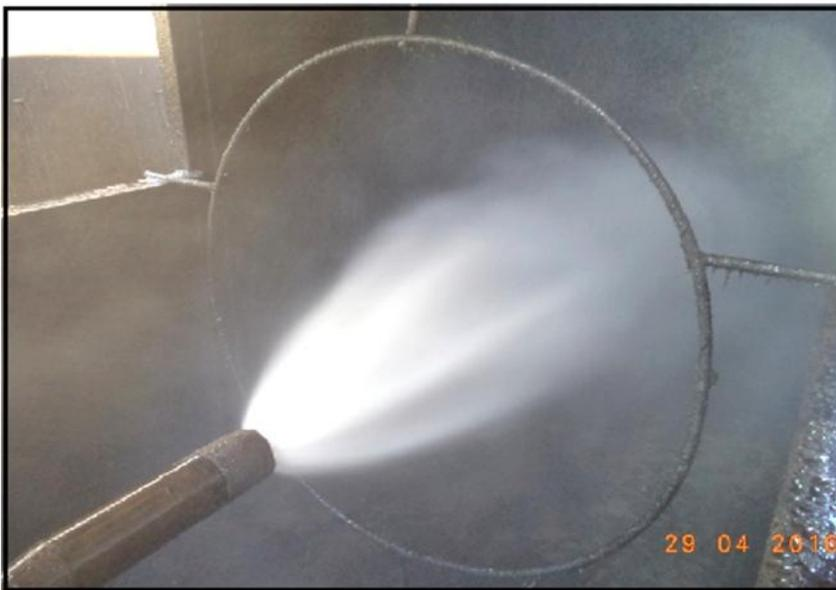
**Figura 3.5.** Atomización adecuada en banco de quemadores
