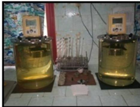
Figura 2.6. Viscosímetro o baño termostático
