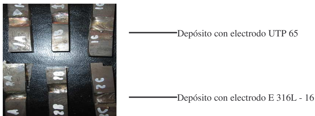
Figura 2.6. Corte de las muestras metalográficas.
