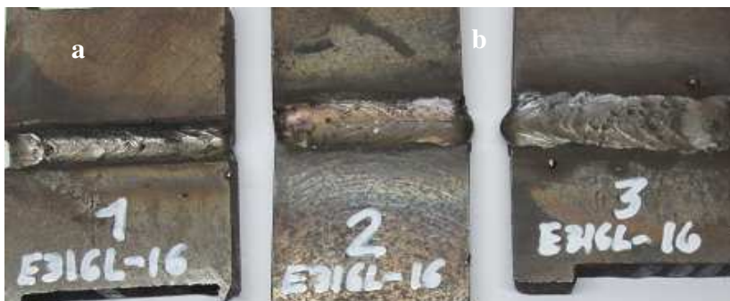
Figura 2.4. Muestras soldadas con electrodos E 316L - 16.
