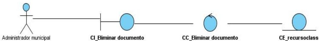
**Figura 20. Diagrama de clases del análisis CU "Eliminar documento".**
