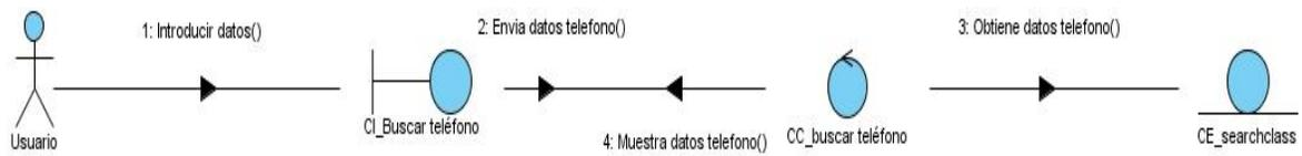
**Figura 33. Diagrama de colaboración del CU “Buscar teléfonos”.**
