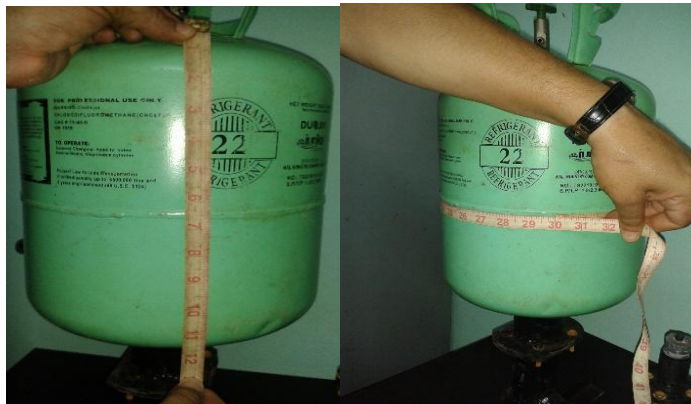
Figura 3.1. Altura y diámetro de la campana
