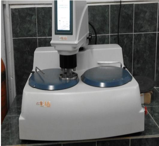
Figura 2.3. Pulidora metalográfica marca PM 52 D.
