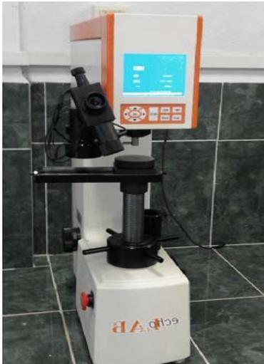
Figura 2.6. Durómetro empleado para la medición de microdureza.
