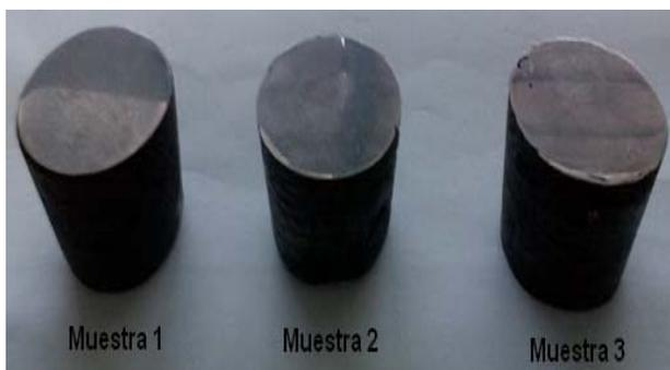
Figura 2.1. Muestras obtenidas producto del moldeo.
