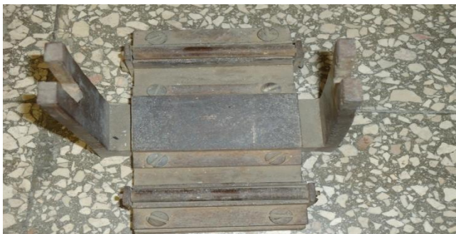
Figura 2.11 Aditamento especial para el ensayo de compresión
