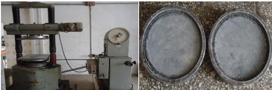
Figura 2.12. Prensa hidráulica de 125 t y anillos de aceros para la realización de la compresión.
