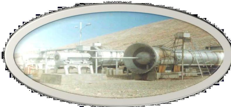
Figura 1.5: Ventiladores tipo Axial.
