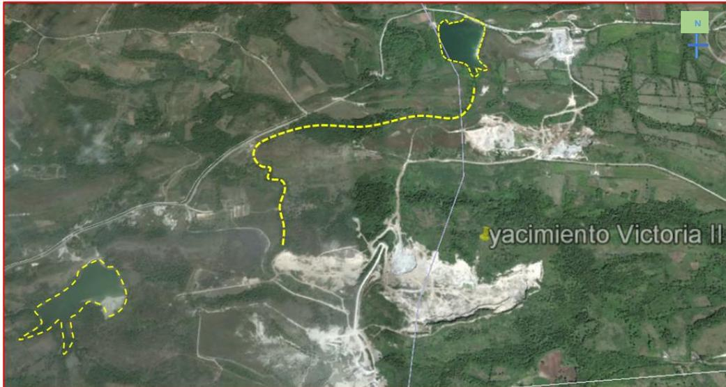
Figura 3.7 Dirección de circulación de agua de drenaje.
