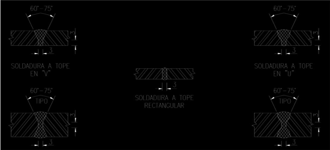
Figura 2.4 Soldadura a tope en U, V y rectangular. Código ASME.
