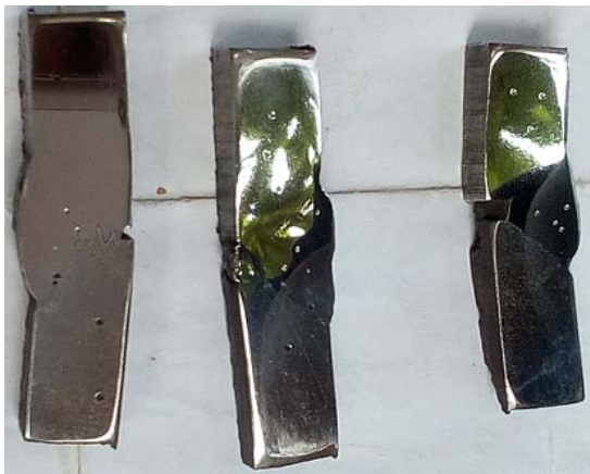
Figura 2.3. Preparación metalográfica de las muestras soldadas.
