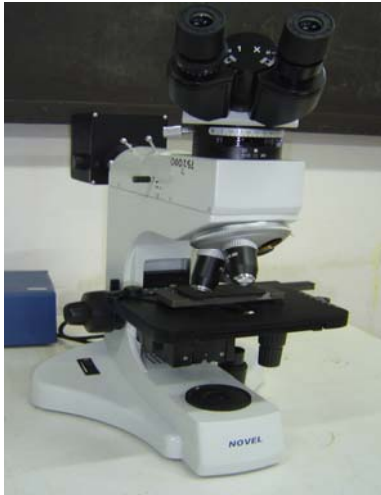
Figura 2.4. Microscopio óptico NOVEL modelo NIM - 100.
