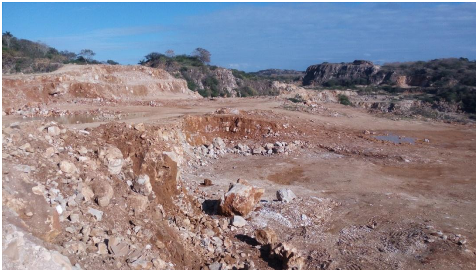
Figura 3.1. Sistema de explotación por bancos descendiente de la cantera San José Sur.
