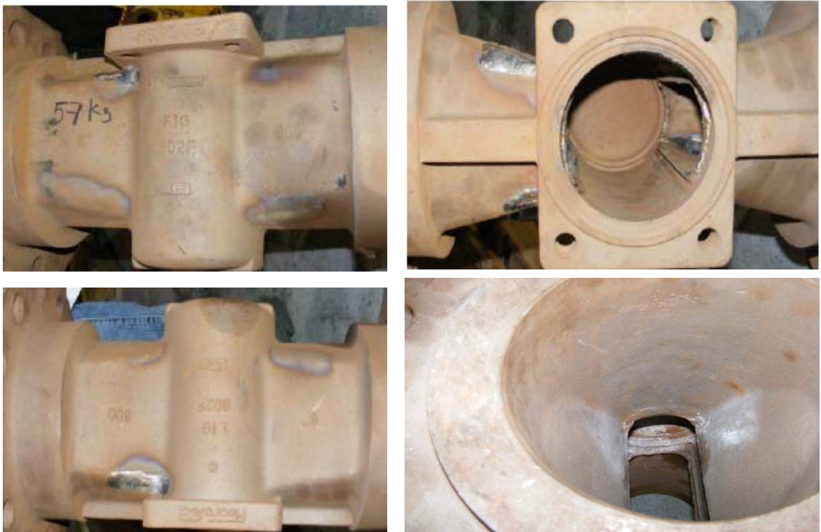
Figura 2. Partes del cuerpo de la válvula recuperado por soldadura.
