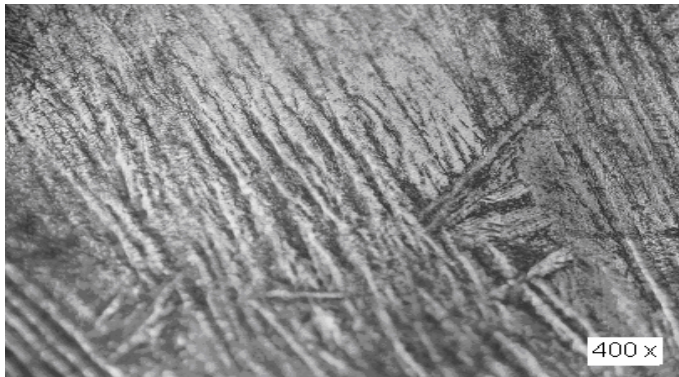
Figura 3.6. Microestructura de la aleación de titanio después del proceso de soldadura.
