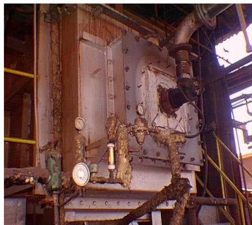
**Figura 2.3 Cámara de combustión del horno de planta piloto.**
