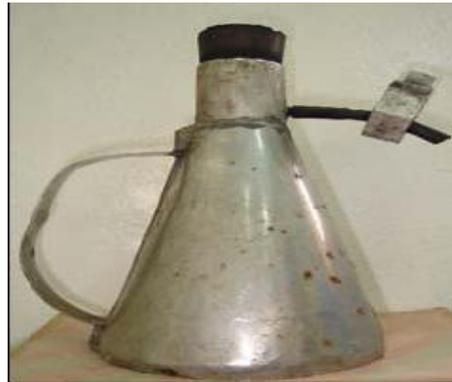
**Figura 2.1 Kitasato para tomar la muestra de mineral reducido.**
